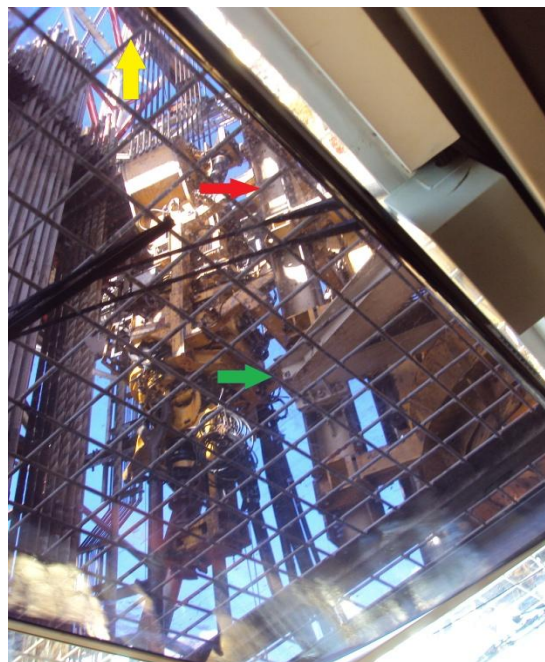
Figura 3 – Visão do top drive da console do sondador (acima do assento do sondador): em vermelho a indicação de 10 (dez) metros de altura, em verde a indicação de 6 (seis) metros de altura e em amarelo a indicação da direção de fixação do braço de suporte da cesta elevatória
