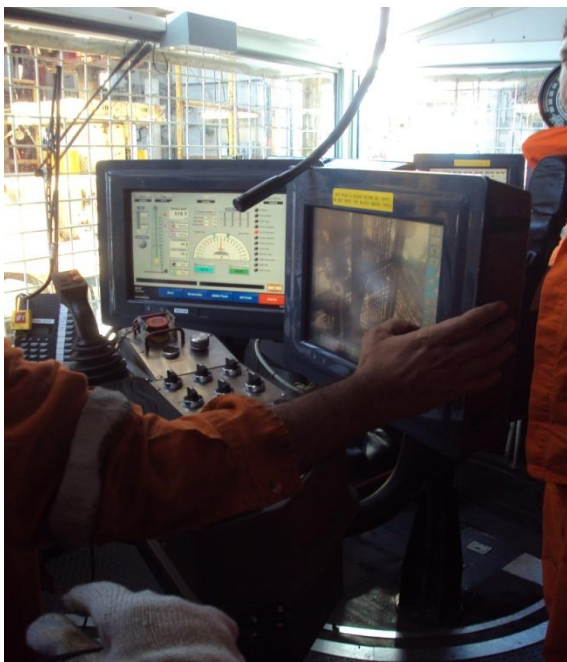
Figura 2 – Console de trabalho do sondador: a tela da direita é do circuito de CFTV com a possibilidade de seleção de todas as câmeras do drill floor
