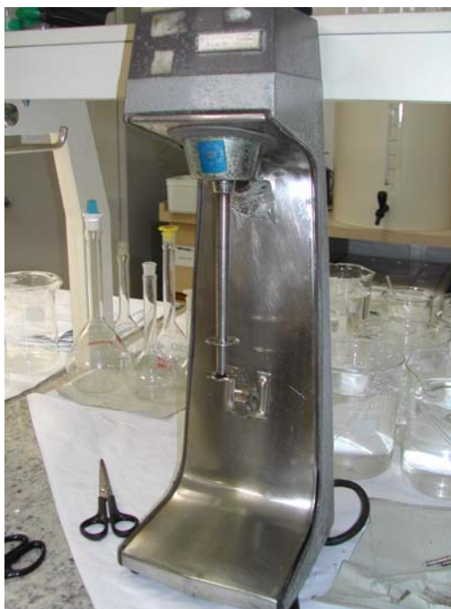
Figura 7. Agitador utilizado no preparo da Fração Óleo-Água.
