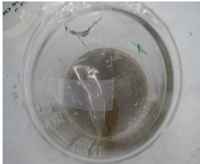
Figura 10. Plástico inserido no interior do béquer para evitar ressuspensão significativa do petróleo para a coluna d'água.
